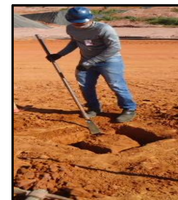
Coleta de Amostra – Determinação Coeficiente de Permeabilidade
